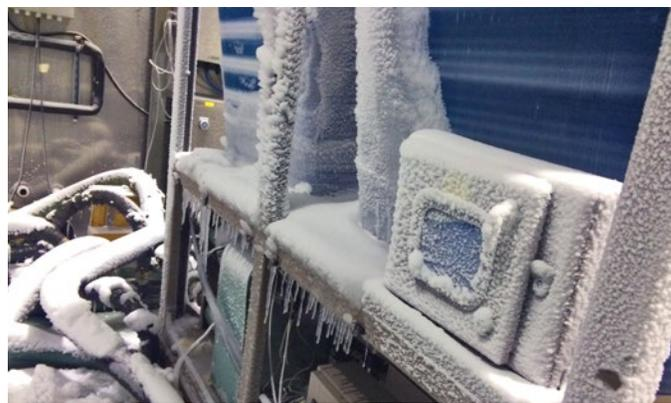
al 1985 e ogni refrigeratore YORK® è sottoposto a Test di Vita Altamente Accelerato (HALT) nelle fasi di sviluppo del design del prodotto permettendoci la simulazione di una varietà di condizioni estreme e assicurandoci un'affidabilità e qualità operative a lungo termine. Ma la nostra ricerca della qualità non si ferma qui.
